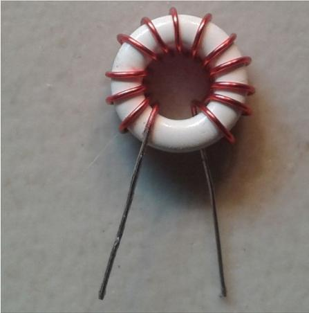
Instale L1 y L2 en el circuito impreso, tire de los rabillos con un alicate para dejarlos tensos, suéldelos y recorte los sobrantes.
